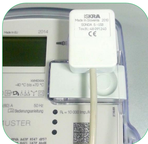
Bild 16: Die Sonde an eine optische Schnittstelle angeschlossen
