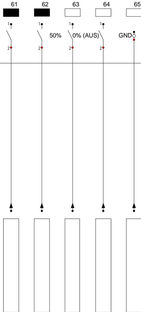
Die Wirkleistungssteuereinrichtung des VNB befindet sich im Wandler-Zähler, bzw. auf dem 3-Punkt Steuergerätefeld (SG-Feld) neben dem Zähler-Wechselschrank. Das anlagenseitige Steuerkabel ist bis in das 3-Punkt SG-Feld zu verlegen.
